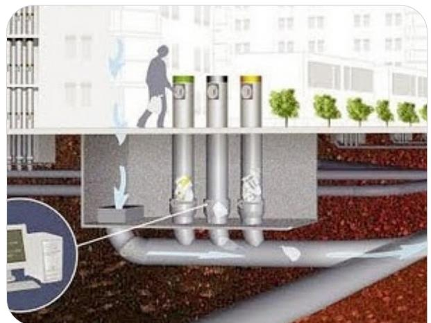
La empresa ENVAC es quien se encarga de la recolección a través de puntos instalados en el Centro Comercial y en los edificios de viviendas. Cuando se llena el área de almacenamiento con basura unos sensores lo detectan y los extractores se ponen en marcha y succionan la Basura a una velocidad de 70 Km/hora. El sistema opera a una distancia máxima de 2 Km y contiene hasta el volumen de 3000 viviendas.
